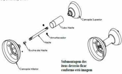
Na imagem mostra a posição que Haste deverá ser montada, com o suporte de fixação para o lado correto.
