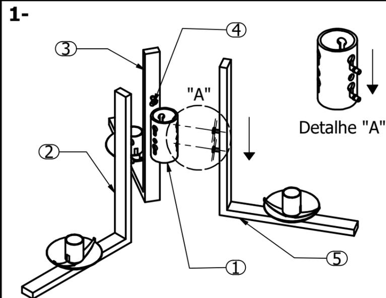
1- -Conforme detalhe "A", insira os itens "L" Montado ("2", "3", "5") encaixe no Eixo Central (1) e puxe-o para baixo para trava.
