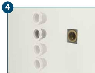
4 Após a retirada do mecanismo, encontre o módulo de redução (F) que melhor se ajusta à base do registro. Atenção: Certifique-se de que a rosca do módulo de redução fique perfeitamente ajustada à base do registro (nem apertada, nem folgada).
