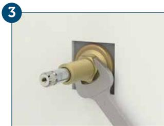
3 Com uma chave de boca (17mm), retire o mecanismo do registro defeituoso da parede girando-o no sentido contrário ao dos ponteiros do relógio.
