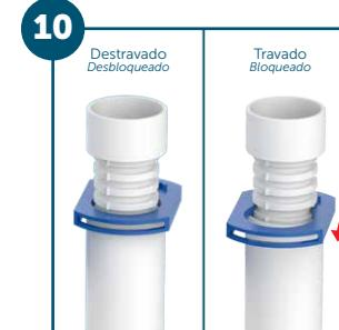
Firme o tubo extravasor (ladrão) e move a trava de fixação.
