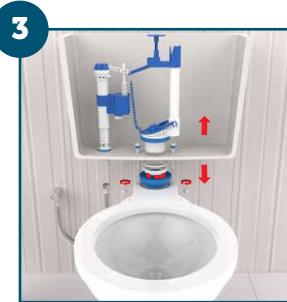
Desosqueie os parafusos de fixação da caixa de descarga e remova o mecanismo defeituoso.
