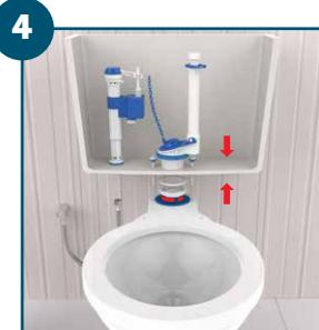
No mesmo furo de onde foi removido o defeituoso, instale o novo mecanismo Blukit e reinstale a caixa de descarga no bacio.
