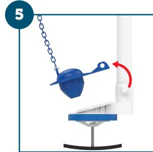
Retire o obturador da base do mecanismo junto à corrente.
