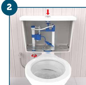
Esvazie a caixa de descarga (se necessário, limpe o interior da caixa) e desosqueie a ligação flexível conectada ao mecanismo de entrada.
