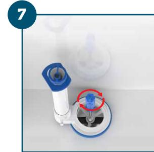
Firme a base do mecanismo girando o parafuso até o final de seu curso (não aperte excessivamente o parafuso para não danificar a louça da caixa).
