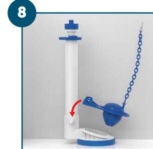
Encaixe novamente o obturador com a corrente do mecanismo em sua base (ver passo 5).
