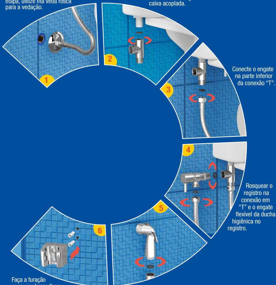
Conecte o engate na parte inferior da conexão "T".
