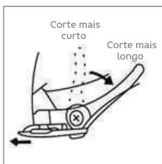
Além disso ela também aumenta a vida útil das lâminas, uma vez que diferentes pontos das lâminas de corte serão utilizados em cada ajuste.
