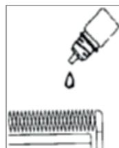
Não utilize óleo de cabelo, graxas, óleos misturados com querosene, solventes ou graxas. Solventes costumam evaporar e deixar o óleo grosso. O uso de lubrificantes inadequados pode reduzir o movimento das lâminas.
