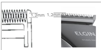
Se as lâminas não estiverem bem alinhadas, adicione algumas gotas de óleo de máquina lubrificante, ligue o cortar por um instante, desligue e desconecte da tomada. Solte um pouco os parafusos que fixam a lâmina, alinhe e reaperte os parafusos.
