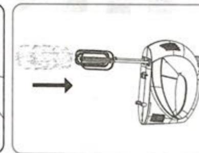
Segure a unidade motora. Encaixe e gire os batedores nos orifícios até encaixar.
