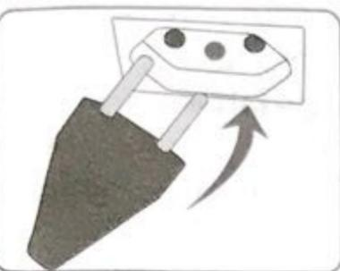
Coloque o plugue em uma tomada de mesma tensão do produto (127v ou 220v).
