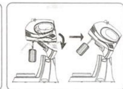
Posicione a unidade motora no topo da plataforma e encaixe a parte traseira no final da plataforma.
