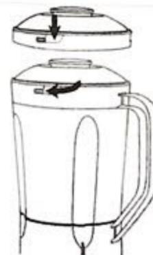
Posicione e gire a tampa de acordo com o encaixe destacado acima.
