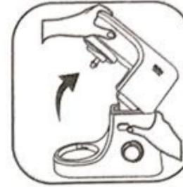
Segure a unidade motora e aperte o botão indicado para mover a unidade motora para cima.
