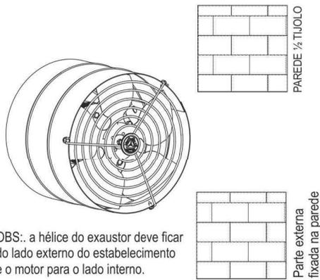
OBS.: a hélice do exaustor deve ficar do lado externo do estabelecimento e o motor para o lado interno.
