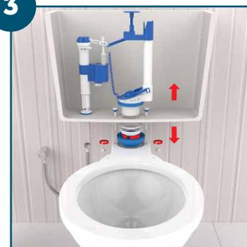
Desrosqueie os parafusos de fixação da caixa de descarga e remova o mecanismo defeituoso.
