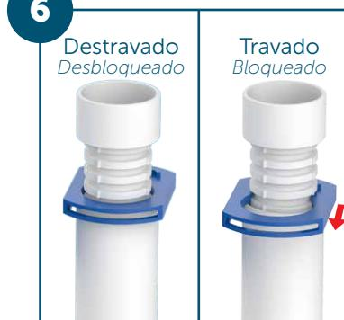
Firme o tubo extravasor (ladrão) e mova a trava de fixação.
