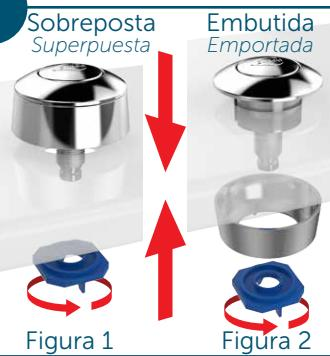
Rosqueie a porca de fixação no acionador. A instalação pode ser **sobreposta** (figura 1) utilizando a canopla prolongadora, ou **embutida** (figura 2) utilizando a mesma como contra-porca na parte inversa da tampa.
