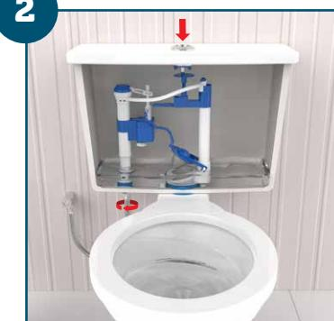
Esvazie a caixa de descarga (se necessário, limpe o interior da caixa) e desrosqueie a ligação flexível conectada ao mecanismo de entrada.
